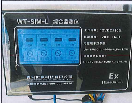
油罐在线渗漏监测系统
