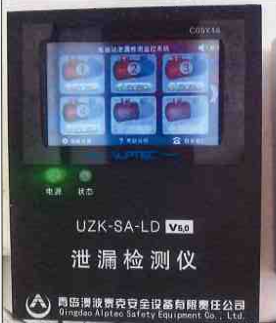
油罐在线泄漏监测系统
