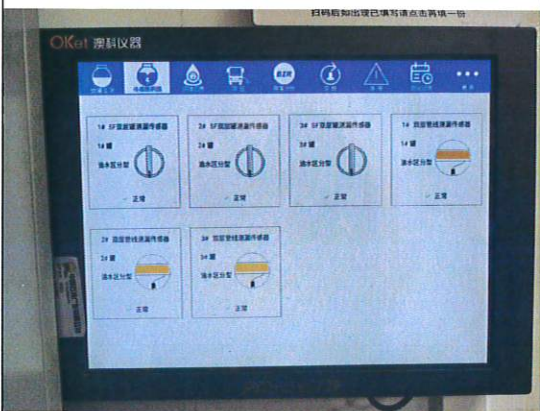
油罐—油管在线渗漏监测系统
