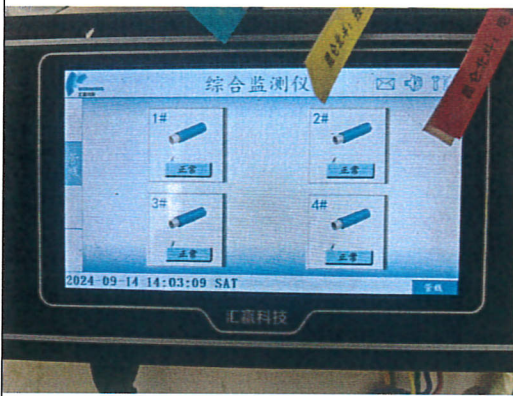
双层管道在线渗漏监测系统
