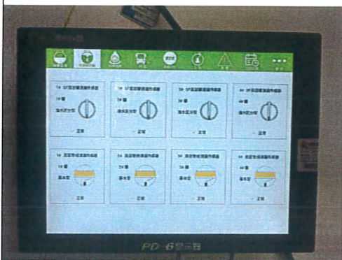
油罐—油管在线渗漏监测系统
