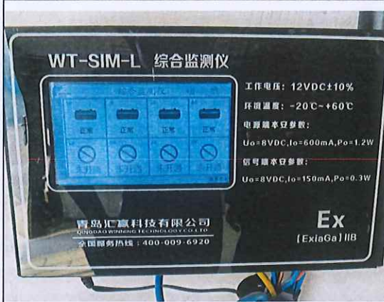
油罐在线渗漏监测系统
