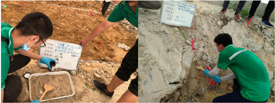
图5.2-3基坑侧壁采样示意图及现场采样照片
