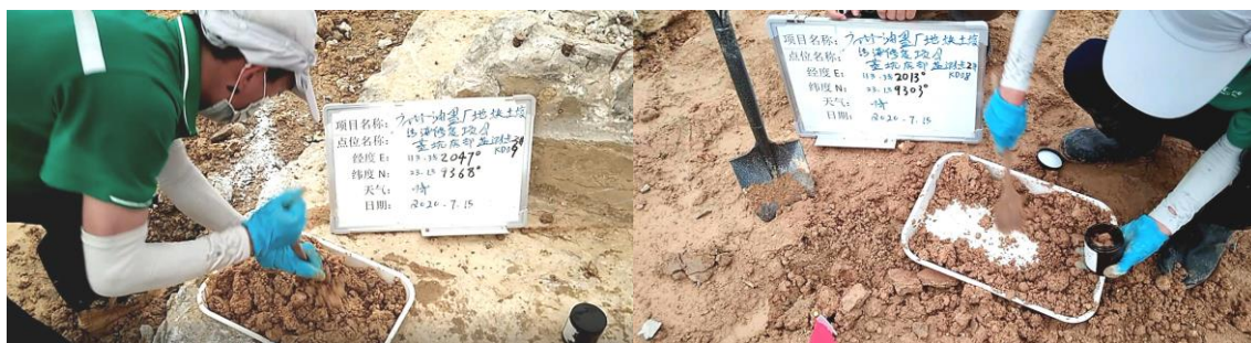
图5.2-2 基坑底部监测单元采样示意图及现场采样照片
